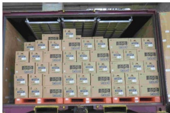
（コンテナ天面下に「エコ調湿資材」を設置）
