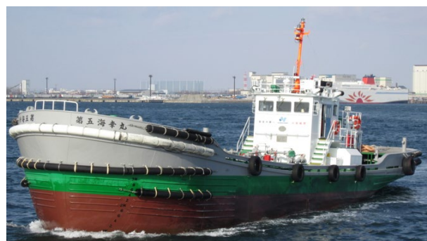
ナラサキ石油が所有するバイオ燃料燃焼実験船（海幸丸）
